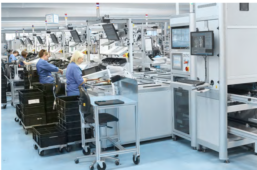
Fertigungslinie mit Handbestückung und abschließender automatischer optischer Inspektion.
