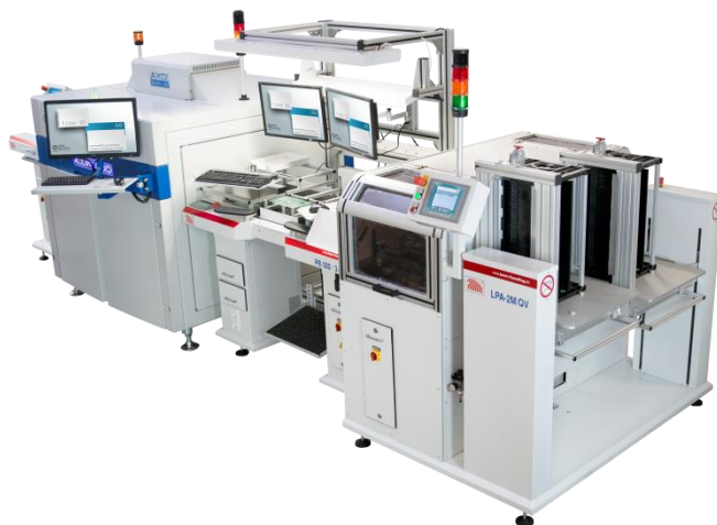
Abb.1: Teil einer Fertigungslinie mit AXI-System und inline-Verifizierplatz
