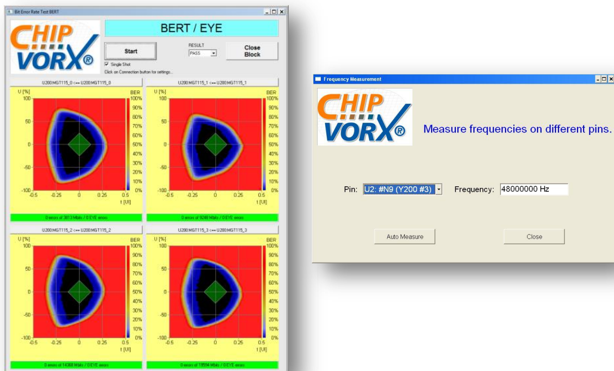
Abb.6: Beispiele zur ChipVORX Visualisierung: BERT-Eye (PCIe x4) und Frequenzmessung
