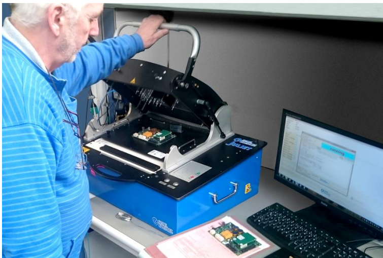
Abb.3: JULIET Desktop-Produktionstester im Prüffeldeinsatz bei BEYERS
