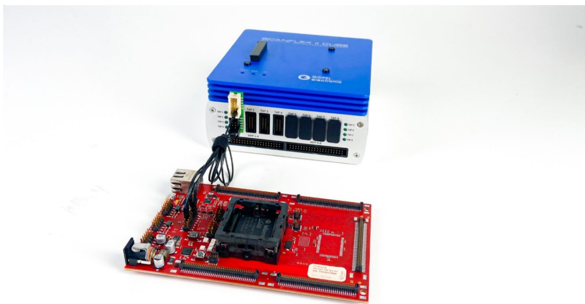
Abbildung 3: Testaufbau: SCANFLEX II CUBE mit angeschlossenem Infineon TC39x Evaluation Board „TriBoard TC3X9 TH V2.01“
