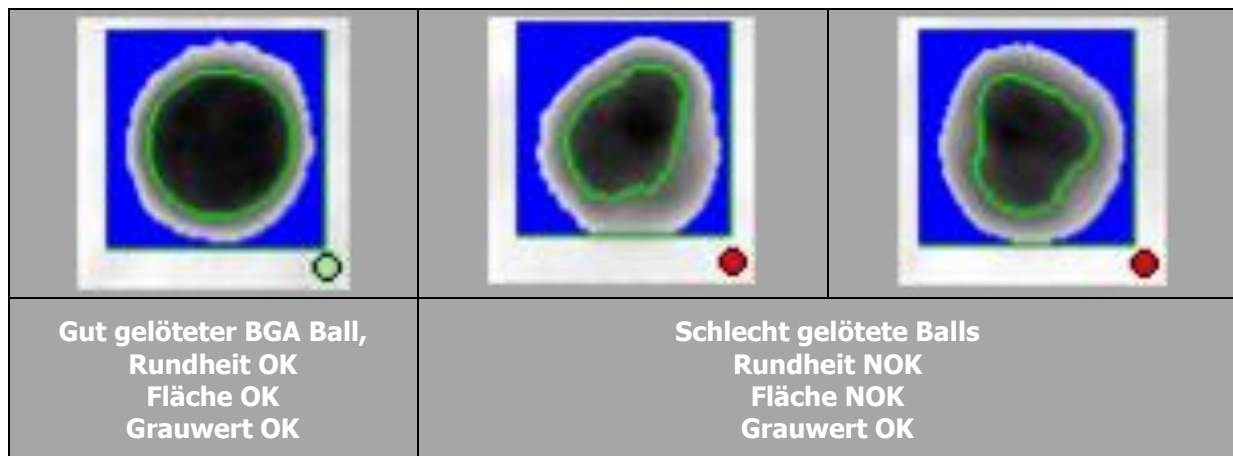
Abb.3: Vermessung guter und schlechter Lötstellen
