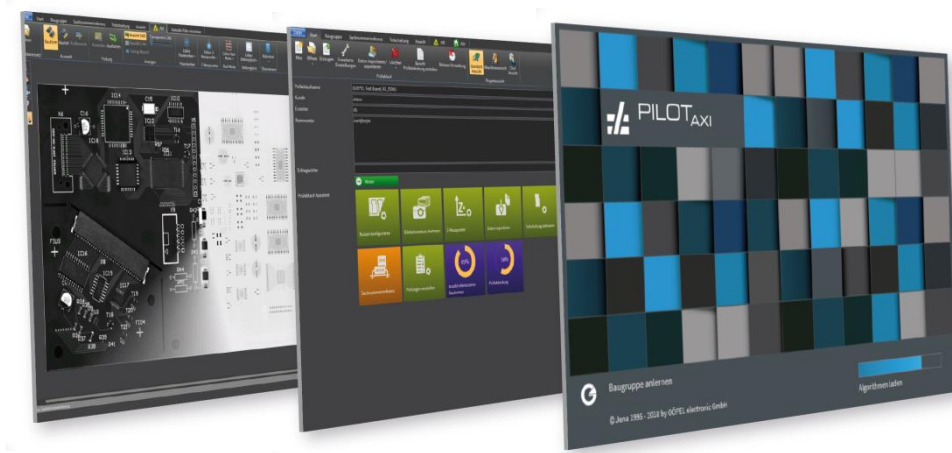
Abb.5: Programmiersoftware PILOT AXI zur Erstellung von AXI-Prüfprogrammen
