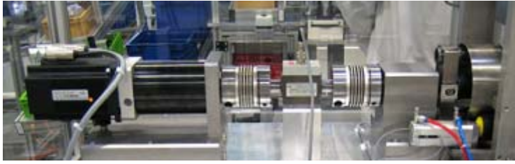
Bild 3: PCS auf dem Prüfstand mit Faltenbalgkupplungen
