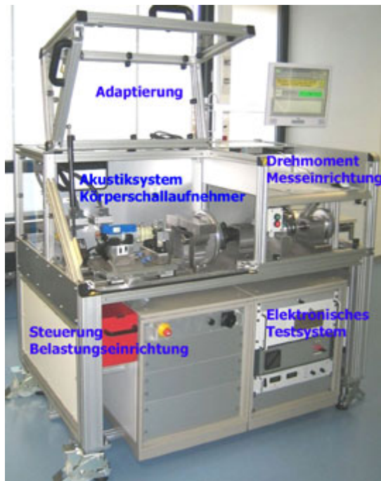
Bild 2: End-of-Line Tester für Heckklappen-PCS
