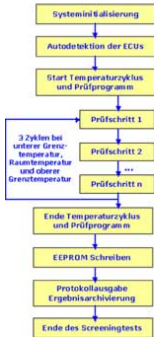
Abbildung 2: Prinzipieller Ablauf des Screeningtests von Kfz-Steuergeräten
