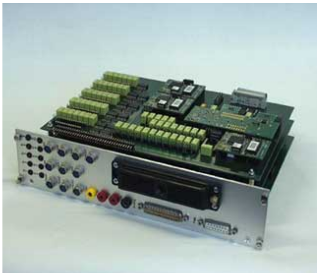
Abbildung 3: Multifunktionsbaugruppe magicCAR in Vollausrüstung mit zwei Erweiterungsboards
