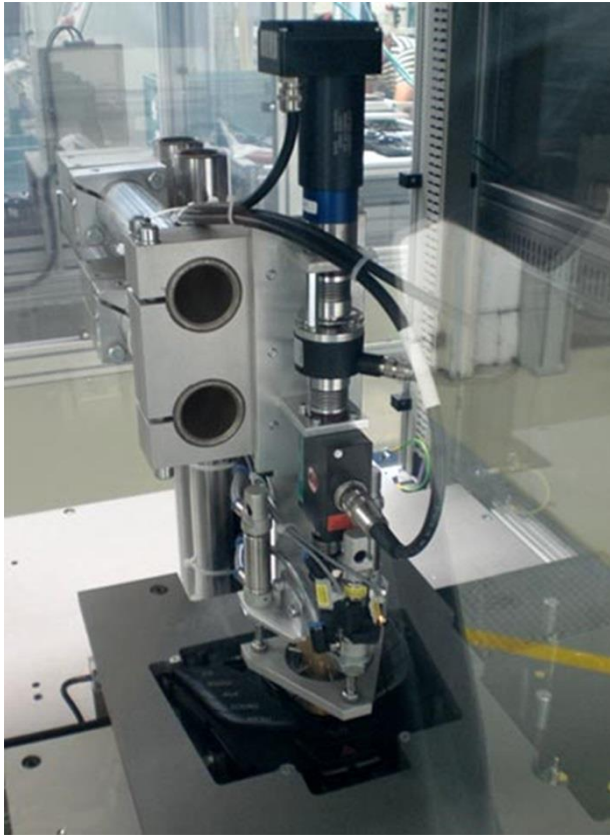
Abbildung 6: Beispielapplikation einer Haptikprüfzelle im End-Of-Line Test von Bedieneinheiten
