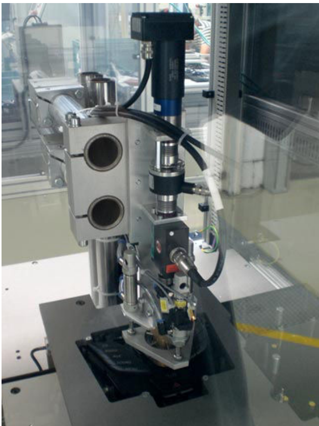
Bild: Haptik-Prüfzelle mit Roboter und Prüfling
