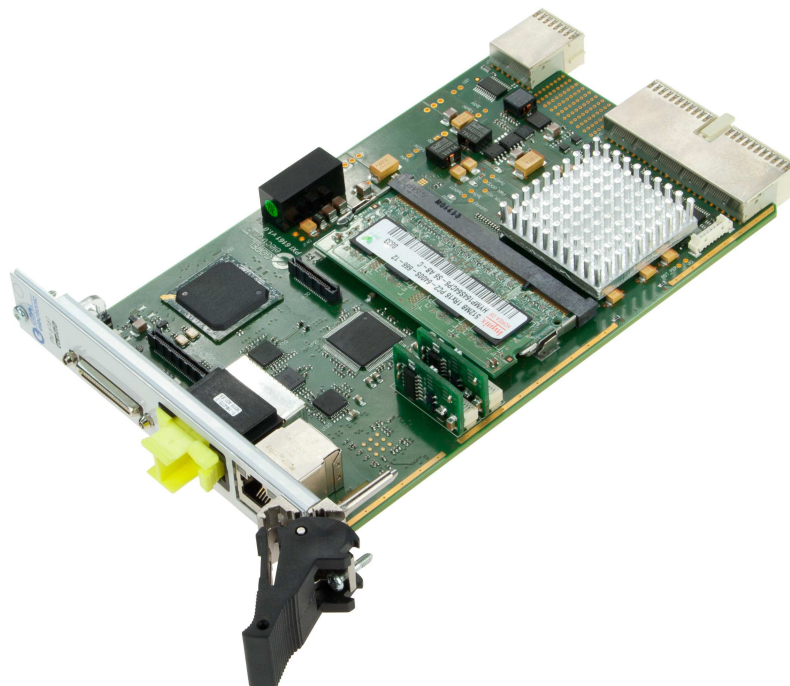
Bild 02: GÖPEL electronic MOST150 Interface 6161
