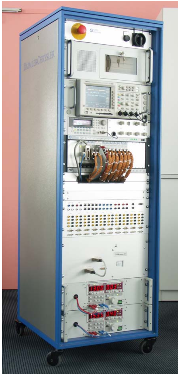
Bild 1: Komplexes Funktionstestsystem für Kfz-Steuergeräte auf PXI-Basis mit integrierter LIN 2.0 Schnittstelle
