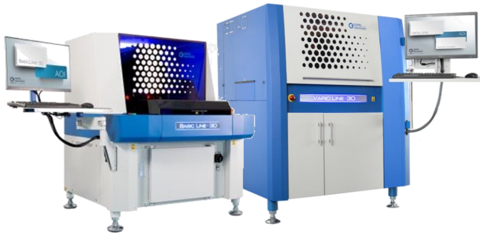
Abb. 3: Die 3D-AOI-Systeme Basic Line · 3D und Vario Line · 3D
