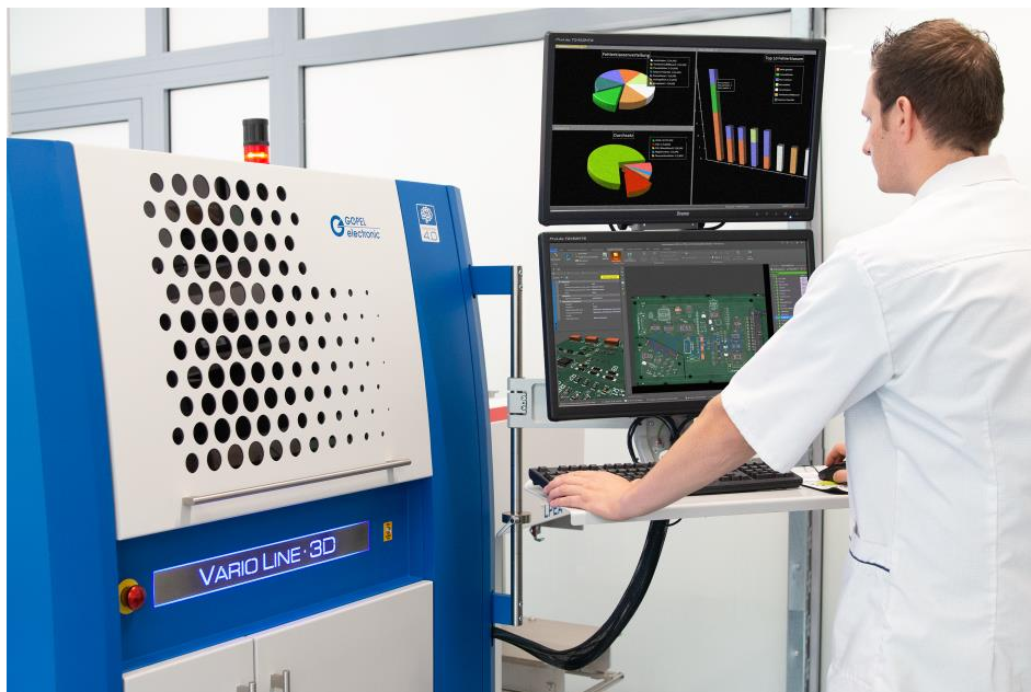
Abb.6: Fehlerstatistik und Prüfprogrammerstellung am System
