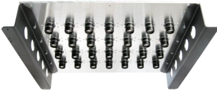
Abb.2: Kameramodul MultiEyeS mit 28 Kameras
