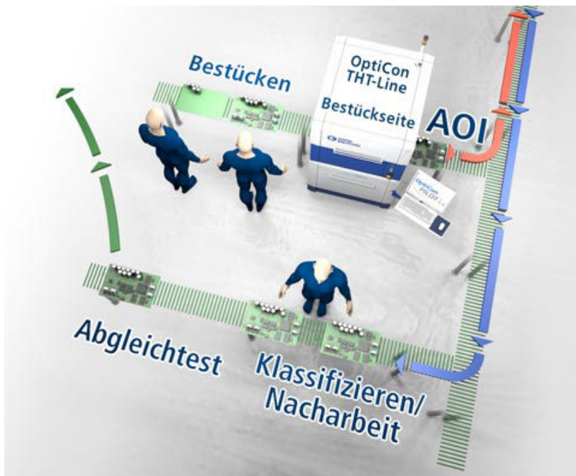
Bild 3: Schema Bestück- und Nacharbeitsplatz
