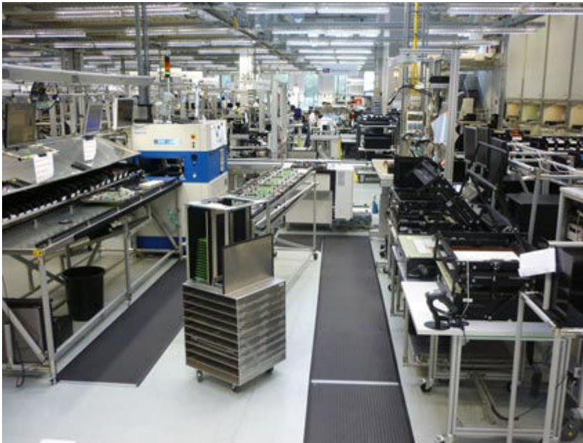
Bild 1: Inselfertigung mit AOI-System OptiCon THT-Line
