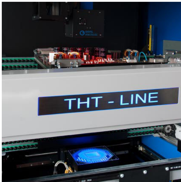
Bild 4: Inspektion der Baugruppenoberseite und -unterseite
