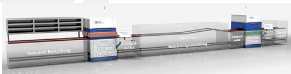
Bild 1: zwei AOI-Systeme für Baugruppenoberseite und -unterseite
