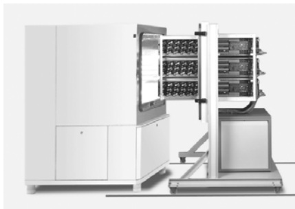
Abb. 5 Funktionstest mit Klimaschrank
